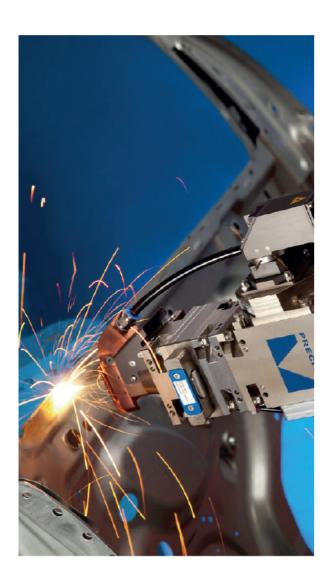
Das Laserschweißverfahren wird an vielen Werkstofftypen angewendet, bei einigen mit reinem Argon oder mit anderen Gasen vermischtem Argon und bei anderen mit Stickstoff. Dabei spielt der Stickstoff in den Laserschweißanwendungen auf edlen Werkstoffen, wie zum Beispiel nicht oxidierende austenitische Stahle, nicht oxidierende ferritische Stahle und die austenitisch-ferritischen Stahle (Duplex), eine große Rolle.
